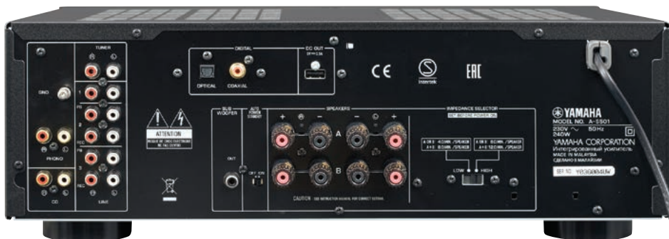
Obok wyjść głośnikowych występuje selektor impedancji – znany od dawna z wielokanałowych amplitunerów Yamaha.
